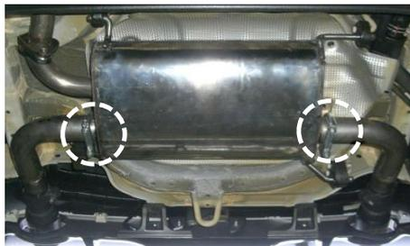
Die Endrohre auf dem Endrohrbogen aufschieben. (Abb. 8)
